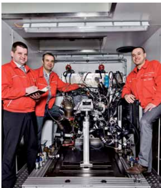
Der Klimabock für Tests unter extremen Bedingungen
